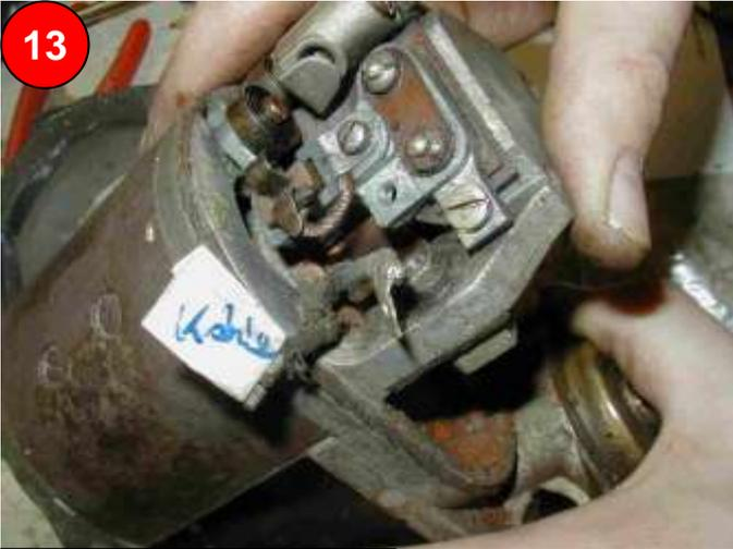
13 Statoranschluss markieren
