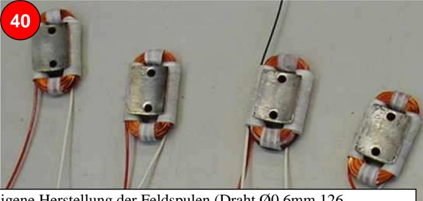
Eigene Herstellung der Feldspulen (Draht Ø0,6mm 126 Wicklungen)
